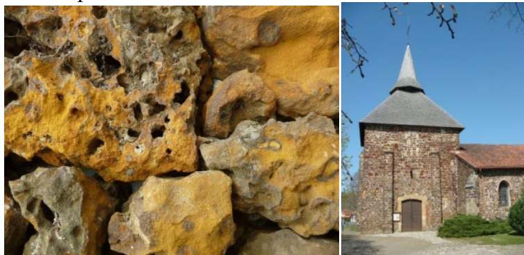
Gauche : La garluche : concrétion de fer qui a servi à la construction et comme minerai de fer
