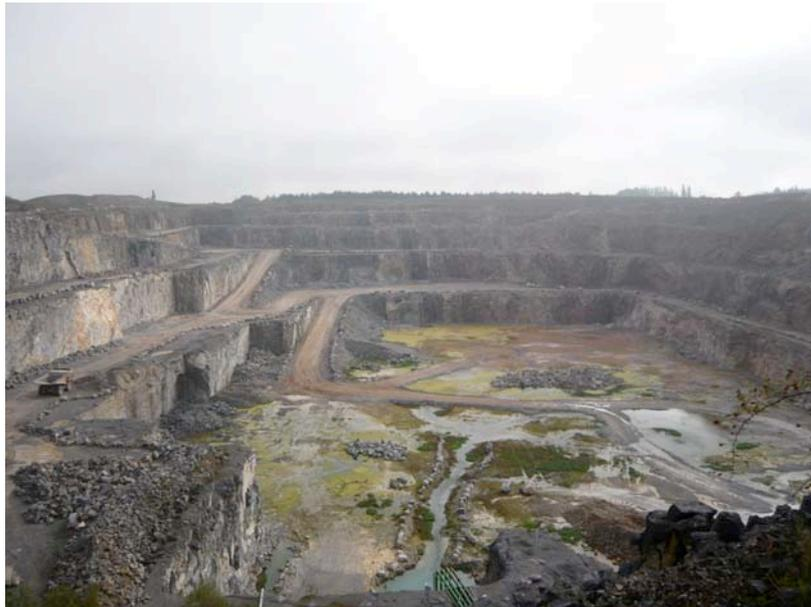
Limont-Fontaine : vue du front est de la carrière Sud et du carreau en eau. L'exploitation se développe sur quatre étages et met en évidence les structures tectoniques complexes dans le coin SE (au fond à droite) de la carrière. La dolomie de Grimont occupe la partie gauche (nord) de la carrière. Cliché A. Blicck.
