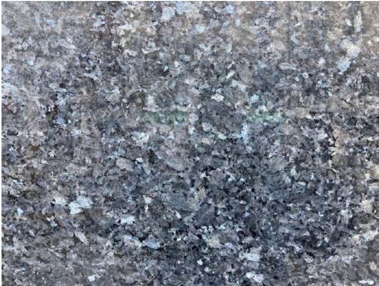
Figure 8: surface polie en Larvikite de la façade du magasin Manor. Les grands cristaux de feldspath ont un diamètre de l'ordre de 2 cm.
