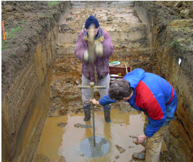
Illustration 10 - Scarpe « gazoduc » : test à la tarière manuelle
